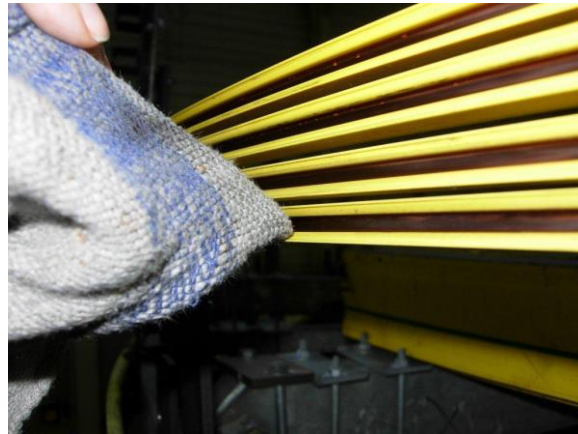
Afbeelding 11: Contacthoek voor het reinigen van de onderste zone
